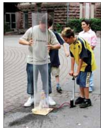
Sicherheitsmaßnahmen beim Raketenstart: eine 200 mm Plexiglasröhre schützt die Kinder
